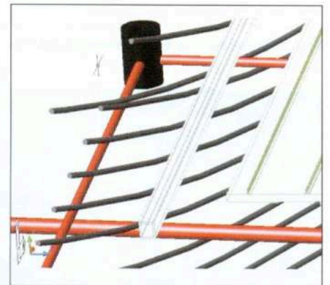
Abb. 7 : CAD 3D-Modell zur Festlegung der Bohrachsen unter Berücksichtigung vorhandener Leitungen
