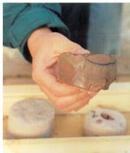
Bohrkern des eingefärbten Injektionsgutes. Rot: Füllinjektion mit geringem Druck, Gelb und Schwarz: Durch Nachinjektion entstandene Fracs
